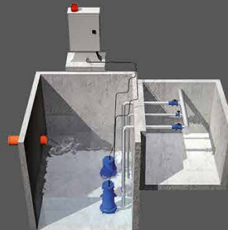
STAZIONI DI SOLLEVAMENTO
